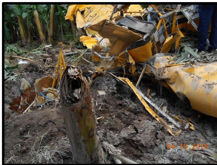
Fotografía No.: 12 Vista del fuselaje y motor enterrado.
